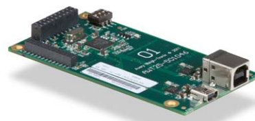
Tarjeta de dispositivo USB Proporciona interconexión USB con el equipo.
