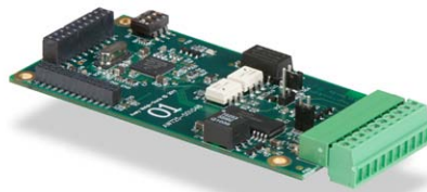
Tarjeta de bucle de corriente Lazo de corriente/RS485/RS422.
