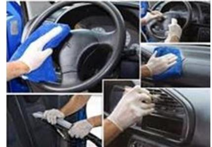
3-Preparar solución de agua y lavandina al 05% (para 1 Lt. litro de solución colocar 81 ml de lavandina y agregar 919 ml de agua o solución desinfectante a base de sales de amonio en 3.5 ml/l de agua ). Rociar utilizando aplicadores manuales en tapizados, cielorrasos, manijas de apertura interna, levanta cristales, tablero, torpeda, freno de mano, palanca de cambios, radios, pedaleras. Repasar con paño limpio y humedecido con la solución preparada en las partes duras.
