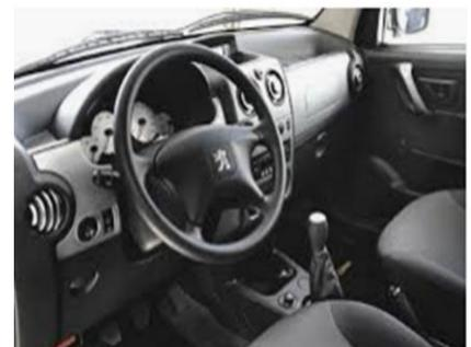
4-Encender el vehículo, luego el sistema de **aire acondicionado** del vehículo o el sistema de ventilación en modo **recirculación y pulverizar debajo del tablero /torpedo** para que ingresen las micro gotas de la preparación y desinfecte el sistema de circulación de aire.
