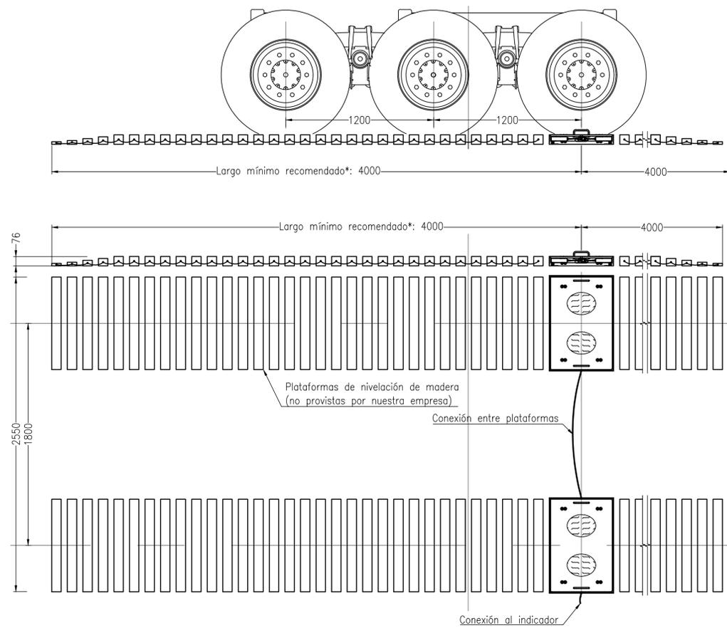
SISTEMA DE PESAJE CON FUNDACIÓN FIJA
